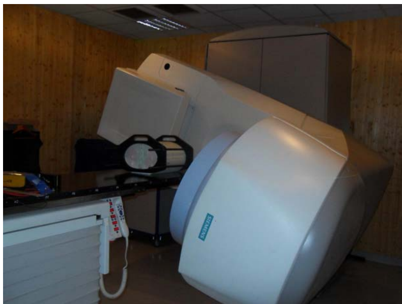
Slika 1.1. Antropomorfni fantom na terapijskom stolu linearnog akceleratora
