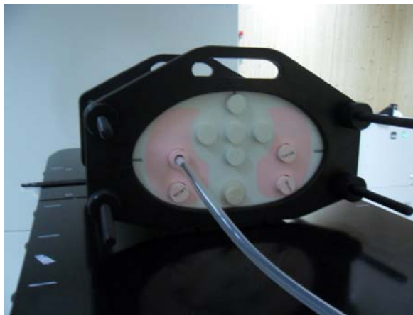
Slika 2.6. CIRS Thorax fantom s ionizacijskom komorom
