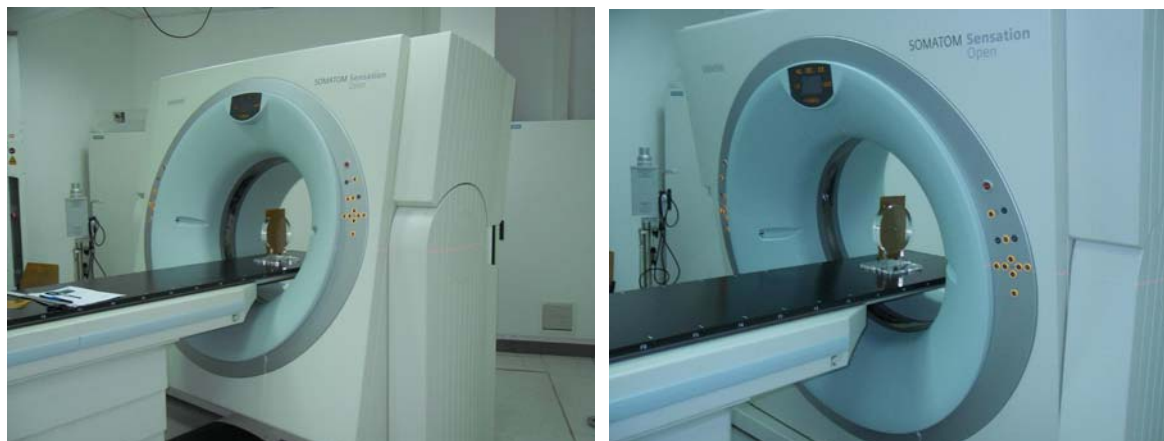
Slika 6. Postavka za provjeru nagiba stativa
