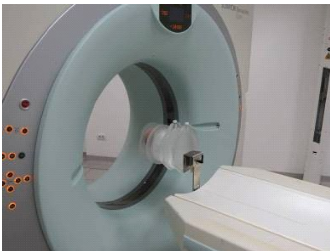
Slika 1. Postav fantoma za verifikaciju parametara
