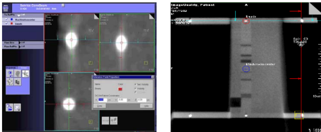
Slika 18: CBCT presjek fantoma za provjeru geometrijske točnosti
