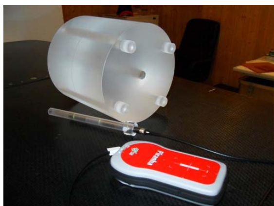
Slika 23: CTDI komora unutar centralnog otvora cilindričnog fantoma
