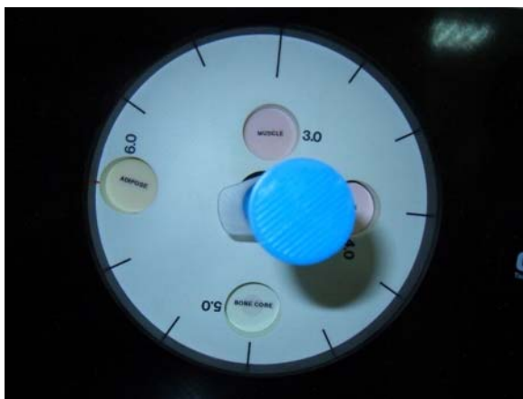
Slika 22: Primjer fantoma za provjeru CT brojeva
