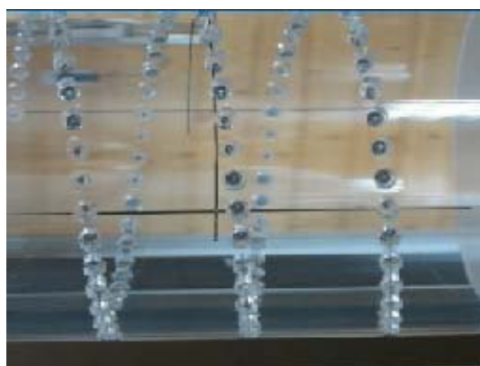
Slika 15: Fantom za geometrijsku kalibraciju MV CBCT-a
