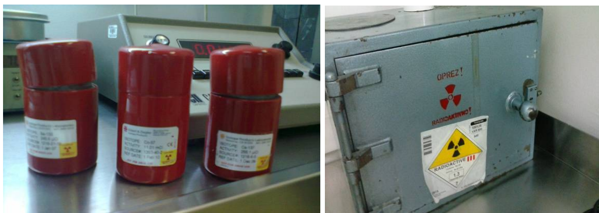
Slika 3. Testni izvori radioaktivnosti Co57, Ba133 i Cs137 i olovni sef.
