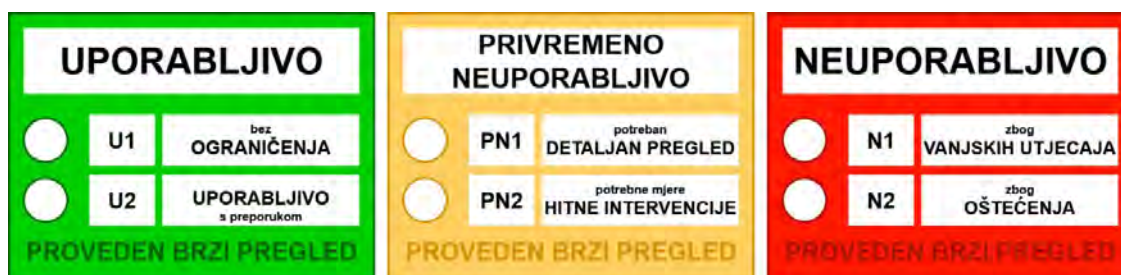
Slika 2. Oznaka kategorizacija oštećenja na građevinama
